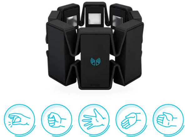
Figura 2. Dispositivo utilizado no trabalho e gestos reconhecidos por ele.
