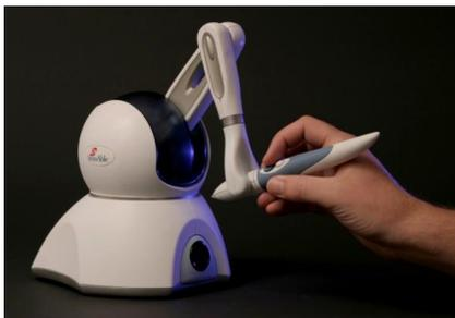
Figura 1. Dispositivo Háptico *PHANToM Omni* da *SensAble Technologies Inc.*
