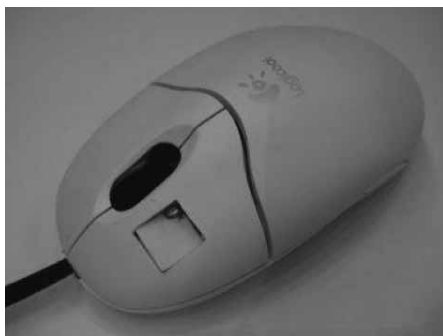
Figura 2.8 – Mouse modificado para fornecer sensação térmica ao dedo do usuário.
