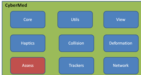
Figura 2 - Estrutura de módulos do CyberMed com destaque para o módulo Assess responsável por realizar a avaliação das ações do usuário. Adaptado de [15].
