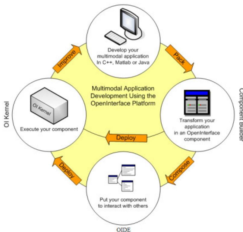
Figura 4.5. Desenvolvimento de uma aplicação multimodal usando a plataforma OpenInterface [Lawson et al. 2008].
