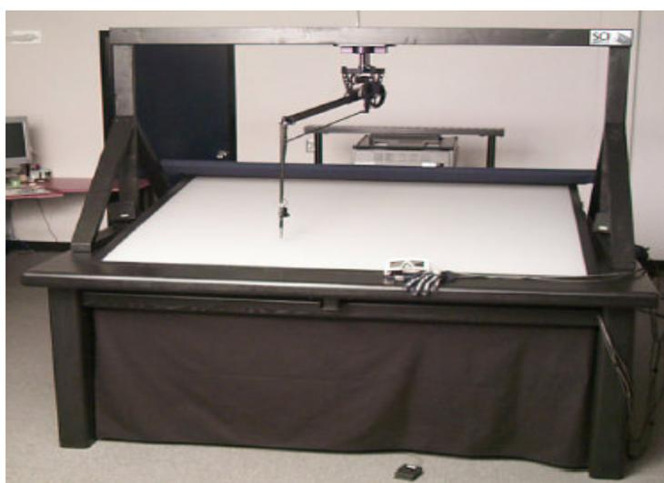
**Figura 3.10. Exemplo de um Workbench Háptico Visual [Hansen *et al.* 2003].**
