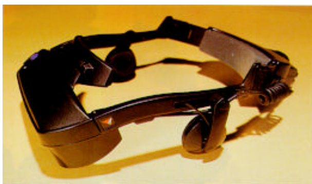
Figura 3-2: No HMD existem sensores (parte de trás do equipamento) que captam os movimentos da cabeça do usuário permitindo que o computador gere a imagem apropriada.
