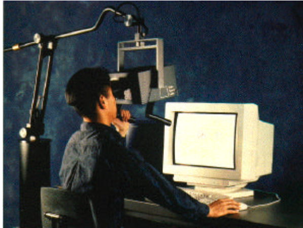
Figura 3-3: O sistema de display estereoscópico BOOM utilizado com uma workstation de alta resolução. Montado sobre um braço articulado com contra-peso, o display permite movimentos com 6DOF [Bolas, 1994].
