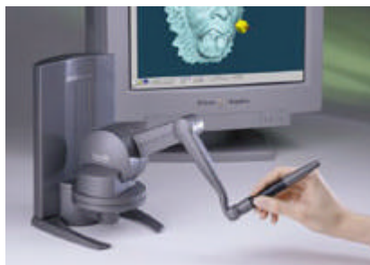
Figura 3-8: Dispositivo háptico Phantom da Sensable [Sensable, 2002].
