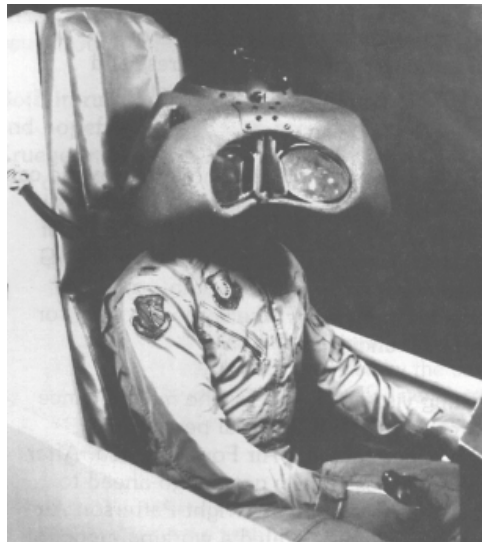
Figura 2-2: Piloto usando o capacete do projeto “Super Cockpit” de Tom Furness [Pimentel, 1995].
