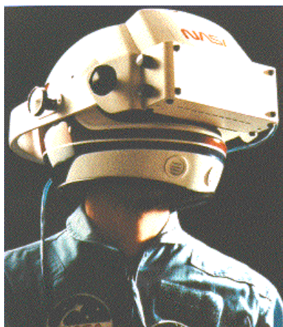
Figura 3-1: HMD desenvolvido na primeira geração de HMDs da NASA [Kalawski, 1993].
