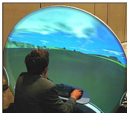
Figura 6: Sistema de projeção semi-esférica.
