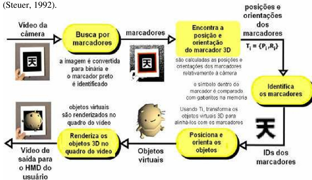
Figura 1. Representação do processo de reconhecimento dos marcadores e o posicionamento de modelos virtuais (traduzido de Kato et al, 2000).
