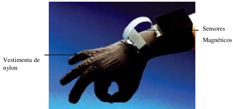
Figura 10. 5DTGlove com sensores magnéticos, onde o receptor detecta a intensidade do sinal sob os três eixos, caracterizando o movimento (Dayeang, 2007)
