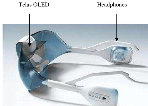
Figura 7. Representação de HMD OLED com duas telas e dois headphones (Vrealities, 2007)
