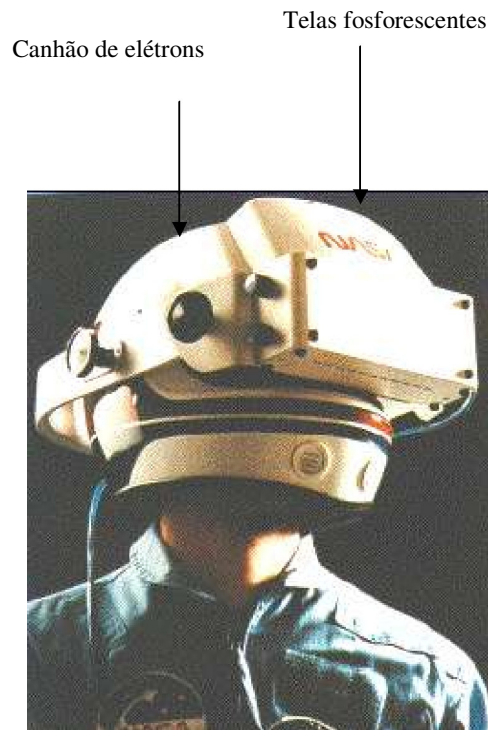
Figura 3. HMD CRT de 2 telas desenvolvido na NASA, onde o canhão de elétrons é posicionado nas laterais do dispositivo, expondo o usuário a altas voltagens próximas da cabeça (Kalawski, 1993).
