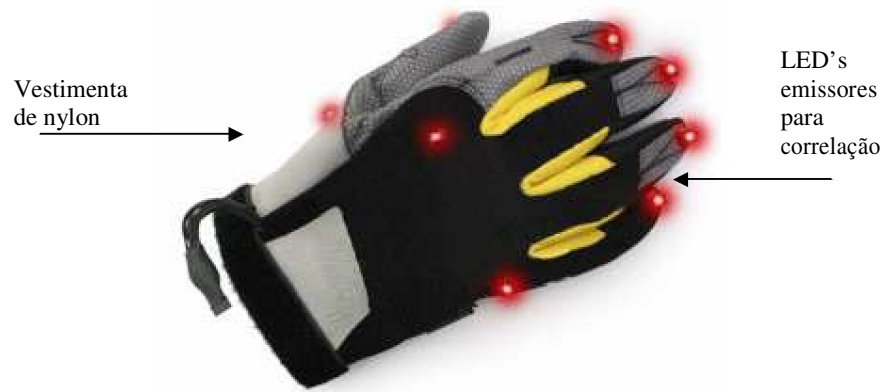
Figura 11. Impulse Glove com rastreamento óptico, que determina a posição por correlação de posições sob diversos emissores LED's (PhaseSpace, 2008)
