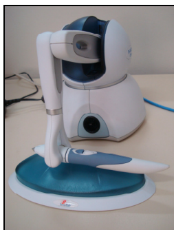
Figura 3. Dispositivo háptico utilizado pelo usuário.
