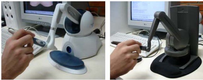
Figura 8.8. Duas versões do dispositivo PHANTOM: Omni e Desktop 1.0. Fonte: fotos da autora.
