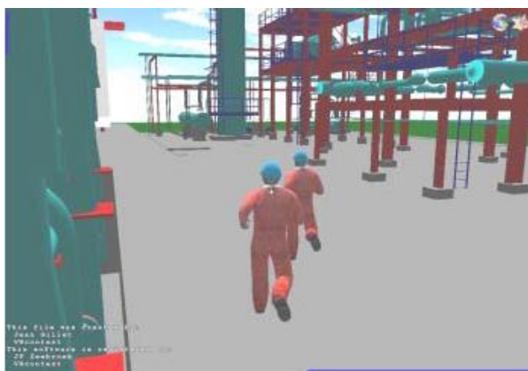
Figura 9.4 – Exemplo de CVE: Walkinside Viewer, para visualização de modelos CAD de engenharia [VRContext, 2007].
