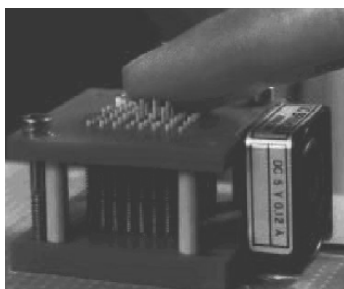
Figure 8.6. Prancha de pinos para reconhecimento de texturas e transições entre objetos. Fonte: Khoudja et al. (2004).
