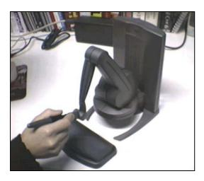
FIGURE, 1 THE PHANTOM DESKTOP IS A ROBOTIC DEVICE FOR FORCE FEEDBACK IN VIRTUAL REALITY SIMULATORS.
