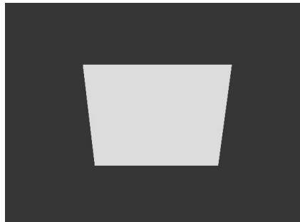
Figura 5: Apresentação de um quadrado rotacionado definido na OpenGL com a diretiva GL_QUADS .
